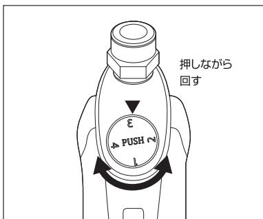
作業に合わせてトルク調整ツマミを1～4(弱～強)に
